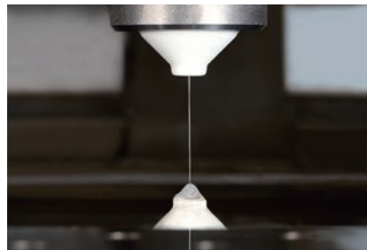
Jet-Feed-Einheit f r D nn Draht Unterst tzt das Einf deln mit D nn Draht durch Wasserstrahl.
