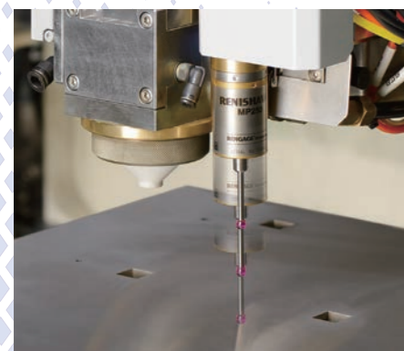
Drei Punkte auf der Oberseite des Werkstücks werden mit dem Taster gemessen und die Neigung des Werkstücks wird berechnet.
