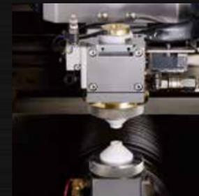
Der Aufbau von oberem und unterem Kopf wurde für schnelle und bequeme Wartung und noch einfachere Drahtausrichtung optimiert.
