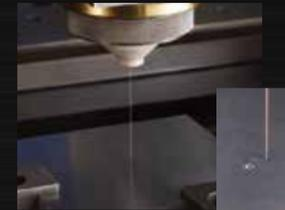
Seibu entwickelte das patentierte trockene Glühverfahren zum Einfädeln bereits 1983. Die neue Ölbadmaschine M25LP fädelt selbst mit Drahtdurchmesser 0,05 mm im Ölbad an der Drahtbruchstelle ein.
